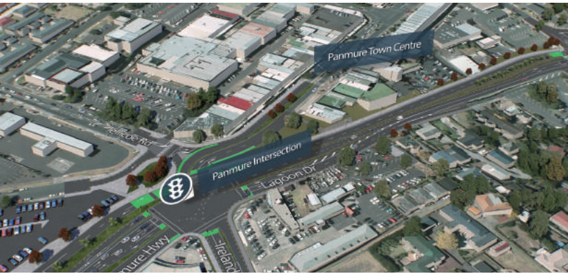
将当前的交通环岛转化成设有交通信号灯的安全交叉路口。
